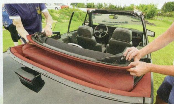
Střecha se zatahuje i odklápí manuálně, případně elektricky. Chromované zámky nad čelním sklem vozu darovala první generace kabrioletu Volkswagen Golf.
