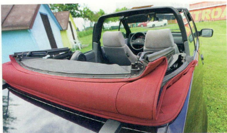
Mechanismus střechy včetně bezpečnostního oblouku využívá stejného principu jako v ostatních německých konkurentech
